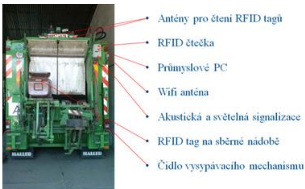
Obrázek 1: Vybavení svozového vozu. Zdroj: Gaben.
